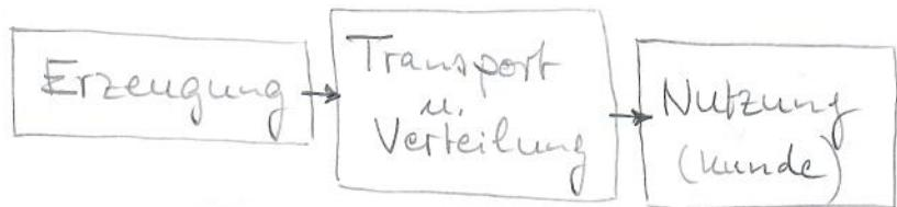
Die öffentliche Versorgung mit elektrischer Energie beruht heute Weltweit auf der Erzeugung von zeitlich sinusförmigen Wechsel-Spannungen, die 3-phäzig (Drehstrom) miteinander verbunden sind. Der wesentliche Vorteil der sinusförmigen Wechselspannung ist die einfache Transformierbarkeit der Spannung,  $\frac{U_1}{U_2} = \frac{N_1}{N_2}$
