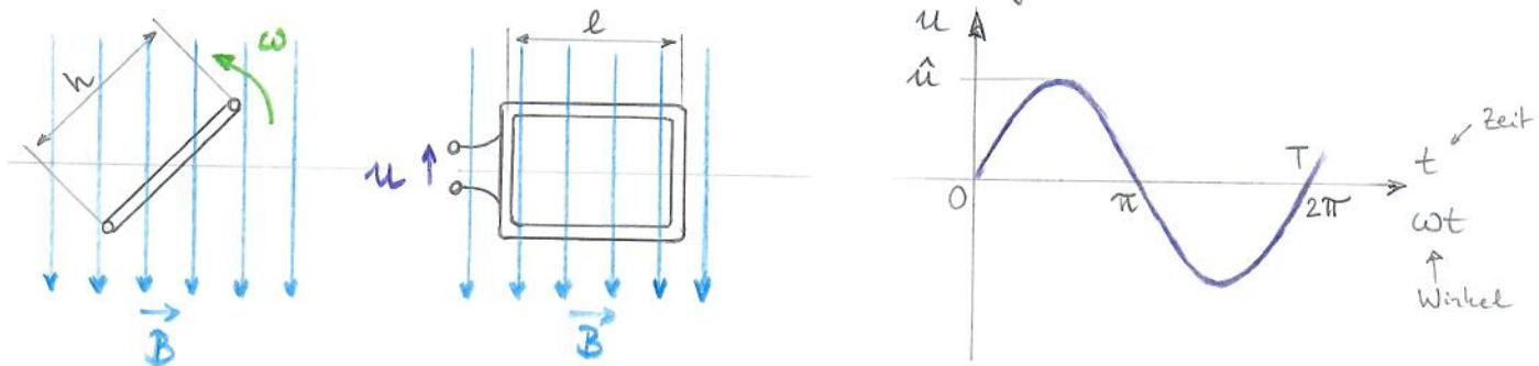
Eine Rechteckspule mit der Höhe  $h$  und der Länge  $l$  rotiert mit der Winkelgeschwindigkeit  $\omega$  in einem homogenen Magnetfeld der Flussdichte  $B$ .
